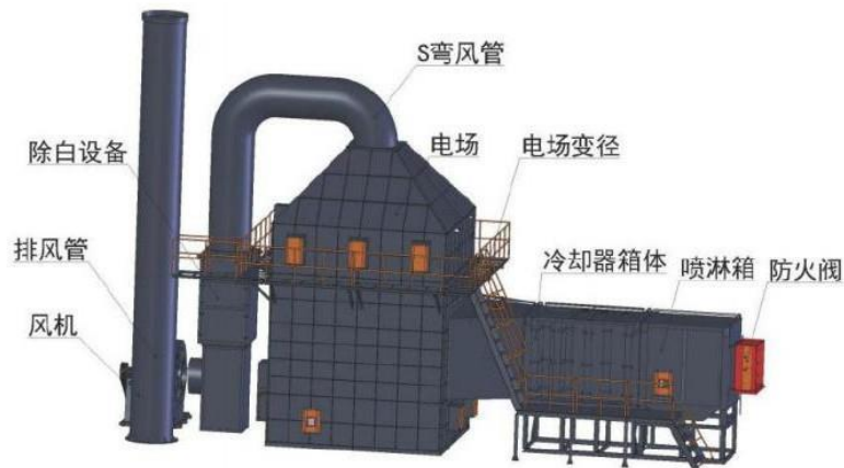
图 6.2-3 “水喷淋+间接冷却+静电净化”设备示意图
